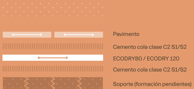
IMPERMEABILIZACIÓN CON LÁMINAS ECODRY80 Y ECODRY120
