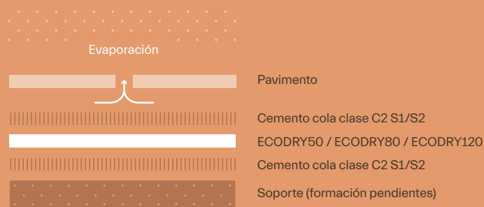
IMPERMEABILIZACIÓN CON LÁMINAS ECDORY50 / ECDORY80 / ECDORY120
